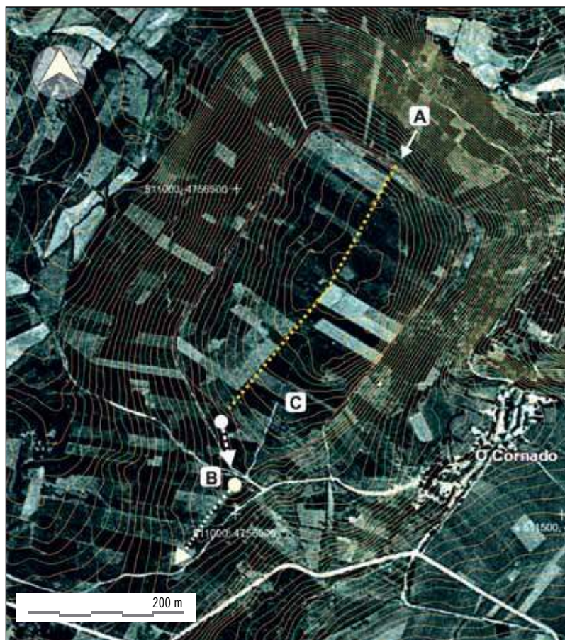
Figura 8. A.- Eje longitudinal interno. B.- Rampa exterior y red de caminos de acceso. C.- Zona sureste donde la nivelación del terreno está asociada a la distorsión de la planta. Fuente CDIX (ortofoto) y IGN (LIDAR para curvado)
