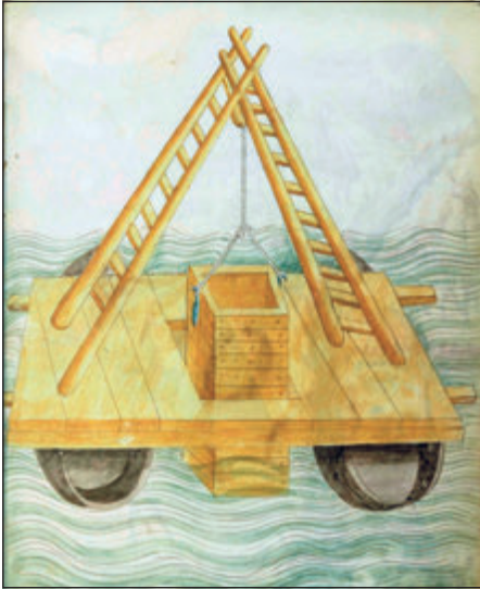
Figura 8. Dibujo del encofrado flotante de Taccola (Taccola ca.1453, Bibliothèque Nationale de France).
