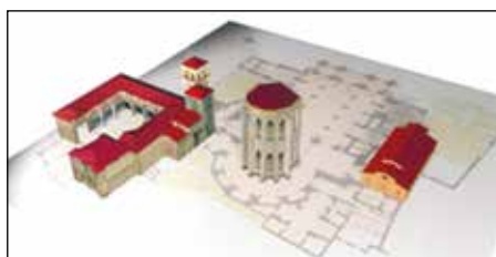
Figura1. Síntesis gráfica del proceso constructivo de la catedral de Oviedo entre los siglos IX a XIII. Imagen tomada de Caso Fernández, et al. (2004). A finales del siglo XI, la "torre vieja" recibió dos nuevos cuerpos para convertirla en campanario. En la segunda mitad del siglo XII, la cubierta de madera de la nave de la Cámara Santa fue sustituida por una bóveda de cañón sobre arcos fajones asociados a columnas sobre las que se talla un apostolado.
