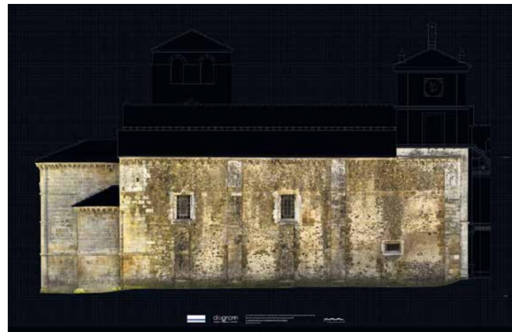
Figura 5. Fotogrametría del alzado exterior septentrional del templo monástico de Cornellana. Elaboración: DOGRAM. Ingeniería de Documentación Tridimensional.
