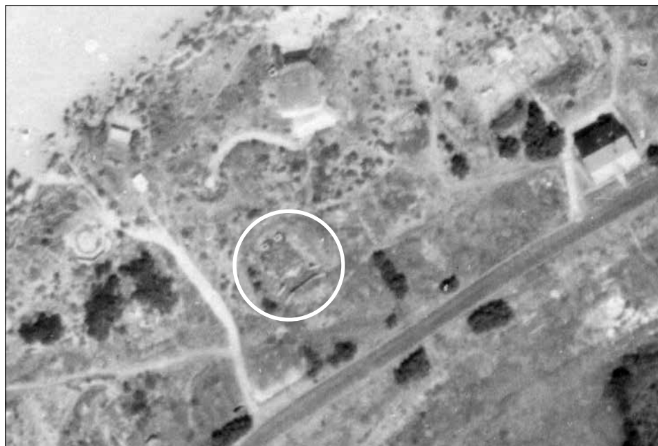
Figura 3. Detalle de la imagen anterior, señalando la posición de dos abrigos para personal a retaguardia de la batería y detrás de las dunas, con la finalidad de incrementar su protección y ocultación.
