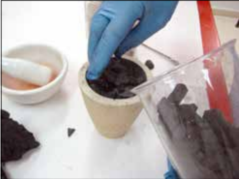
Figura 11. Se añade el carbón vegetal triturado hasta llegar a las tres cuartas partes del volumen del crisol.
