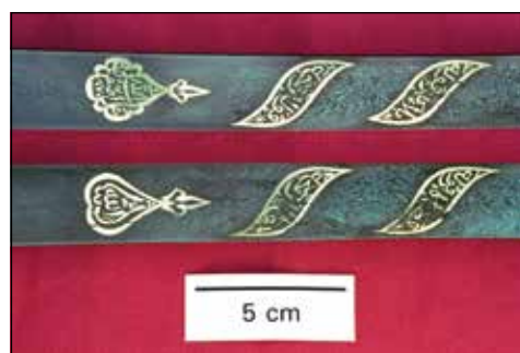
Figura 2. Imagen del shamshir de Mehemet Ali (Museo del Ejército, Toledo, España), en el que se observan, con detalle, las vetas sinuosas junto con los nihelados en oro del maestro Assad Alláh.
