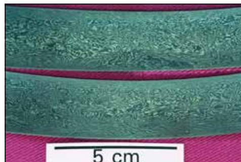
Figura 1. Imagen del shamshir de Mehemet Ali (Museo de Ejército, Toledo, España), en el que se observan con claridad las vetas sinuosas del legítimo acero de Damasco.
