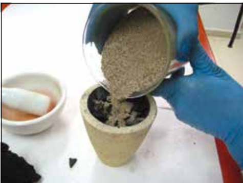
Figura 12. Se rellena y enrasa el crisol con la arena de río.
