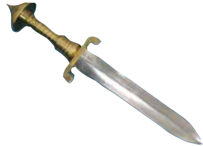
Figura 27. Puñal forjado con acero de Damasco templado en aceite.
