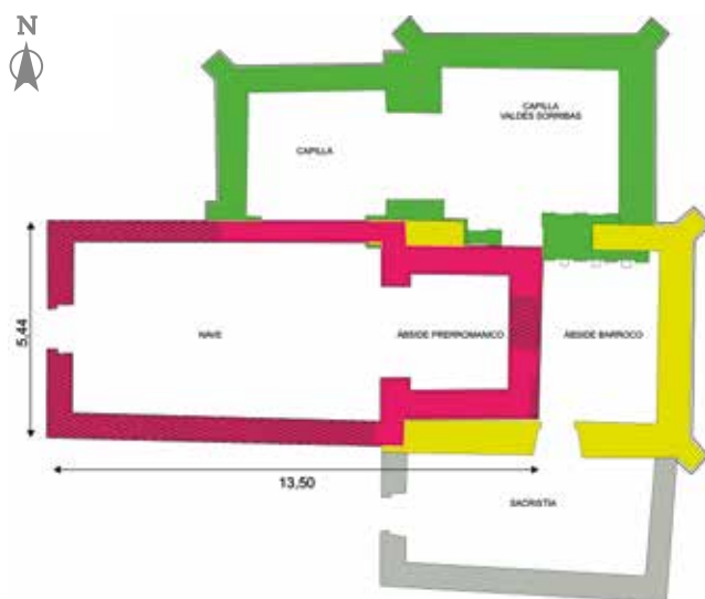
Figura 3. Planta de la iglesia prerrománica con indicación del posible trazado del ábside y los añadidos de época barroca (cabecera, capillas) y moderna (sacristía).
