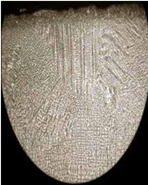
Figura 25. Macrografía de la sección de uno de los lingotes obtenidos por carburización a 1300 °C durante 12-16 horas, obsérvese la estructura dendrítica de este acero ledeburítico del 1,8 % C en masa.
