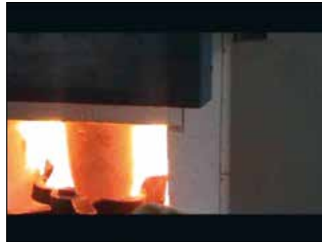
Figura 14. Introducción en el horno del crisol sellado a una temperatura de 1350 °C, durante 12-16 horas.
