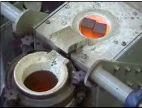
Figura 7. Se observan dos barras de hierro ARMCO en el crisol, en el momento de comenzar la fusión.
