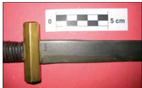
Figura 24. Puñal de acero de Damasco con bandas de carburos de hierro muy finas, templado y sin ataque.
