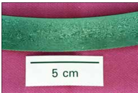
Figura 26. Marcas superficiales en el shamshir de Mehemet Ali forjado por Assad Allâh al-Isfahâni.
