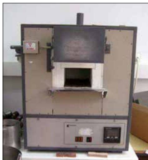
Figura 10. Horno utilizado para la obtención de los wootz por carburización.
