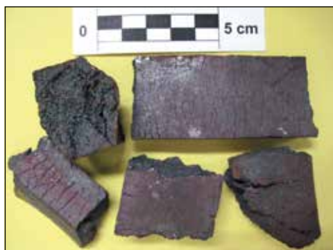
Figura 17. Trozos de una pletina de acero indio forjada a temperatura inadecuada (superior a 800 °C).
