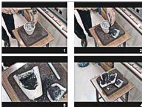
Figura 15. Se rompe el crisol y se observa el lingote, la capa de arena vitrificada sellante y parte del carbón aún sin consumir.
