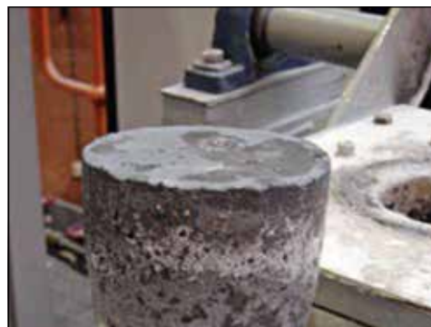
Figura 9. Imagen del lingote obtenido por enfriamiento en crisol.
