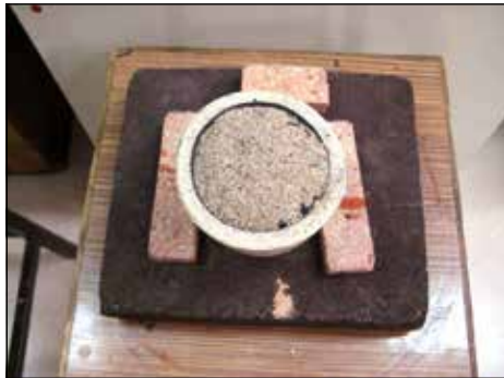
Figura 13. El crisol queda con el lingote y el carbón vegetal sellado con la arena de río.
