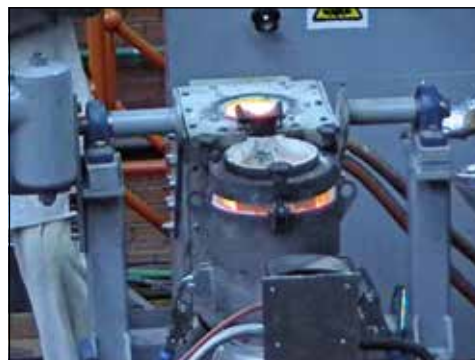
Figura 5. Horno eléctrico de alta frecuencia utilizado en la obtención de hierros y acero de Damasco directo. El molde o lingotera se calienta por combustión de gas.
