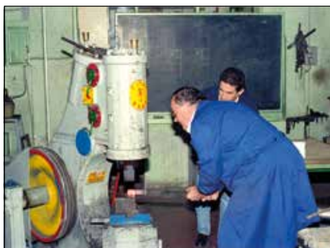
Figura 18. Martillo pilón neumático para desbastar una pletina de acero indio.
