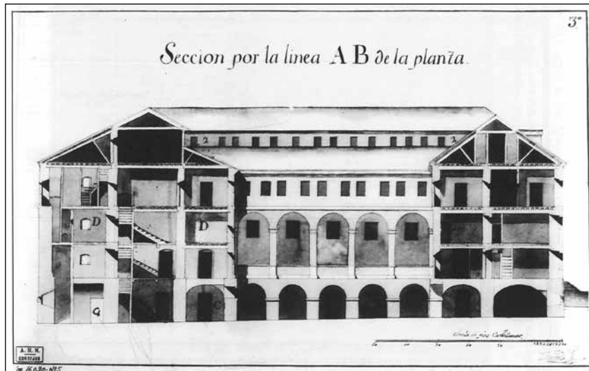
Fig. 4. Sección por la línea A B de la planta. Dibujado en 1792 por Francisco Antonio Muñoz Lorenzana (Madrid 1997a:24; Tuñón Escalada 2000:796-799).
