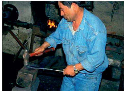
Figura 20. Imágenes de la forja de un puñal por el maestro herrero Juan Pozón (Córdoba).
