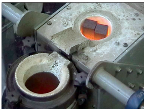
Figura 7. Se observan dos barras de hierro ARMCO en el crisol, en el momento de comenzar la fusión.
