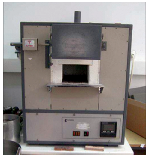
Figura 10. Horno utilizado para la obtención de los wootz por carburización.
