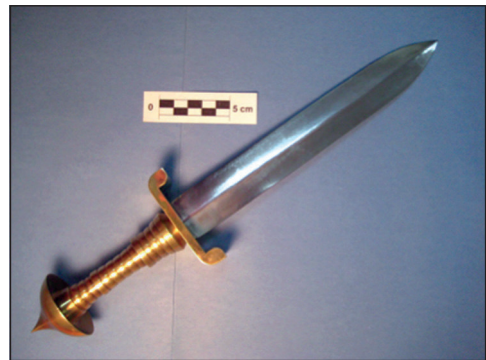
Figura 23. Puñales de acero de Damasco pulidos sin ataque. Presentan un brillo muy transparente y especular.
