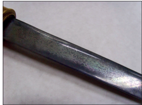
Figura 22. Puñal de acero de Damasco atacado con cloruro férrico en solución alcohólica ácida. Se observan las bandas de carburos de hierro en red poligonal.
