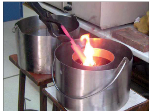
Figura 21. El puñal al rojo sangre se sumerge en aceite para su temple.
