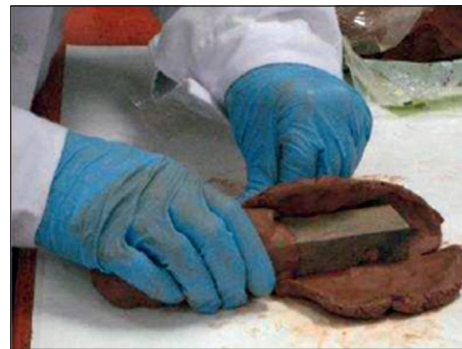
Figura 16. Sellado con arcilla de una pletina de acero indio y tratamiento de recocido de ablandamiento.
