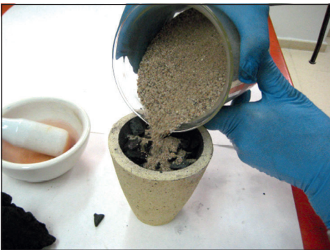
Figura 12. Se rellena y enrasa el crisol con la arena de río.
