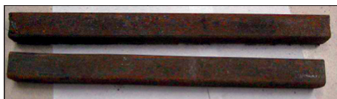
Figura 6. Materiales de partida: barras de hierro ARMCO, de aproximadamente 70 cm de longitud, y ferroaleaciones.
