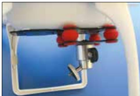
Figura 5. Detalle del sistema que construimos para poder adaptar una cámara de fotos estándar al Phantom.
